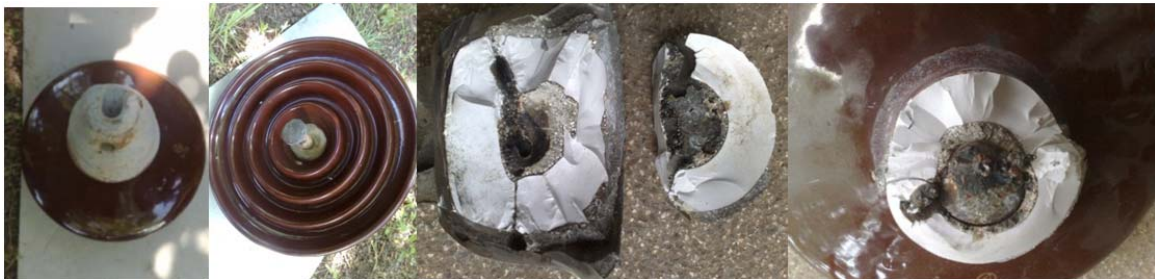
Slika 1- Slomljeni izolatori i strujne staze kroz keramiku
